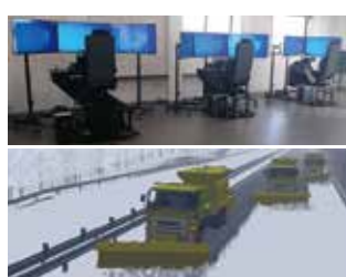
2020年12月 NEXCO中日本グループ 除雪車両運転教育用の 「車両操作シミュレータ」
