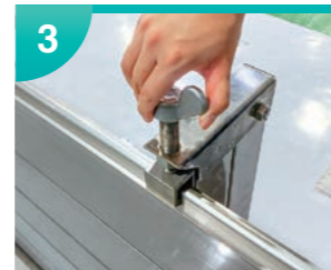
Pボルトでサポート支柱を上下方向に締め付け、止水パネルをしっかり固定します。
